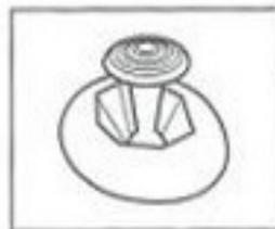
Si le **STICK MULTIDIRECTIONNEL** est tenu à un certain angle (comme sur l'illustration de gauche) lors de la mise en marche, cette position deviendra la position neutre et les jeux utilisant le stick multidirectionnel ne fonctionneront pas correctement.
