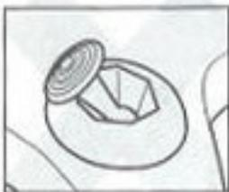
La manette de la Nintendo® 64 contient un **STICK MULTIDIRECTIONNEL** qui utilise un système analogique pour la lecture des angles et de la direction de ses mouvements. Un tel système permet un contrôle dont la subtilité dépasse de loin celle d'une **MANETTE CONVENTIONNELLE**.
