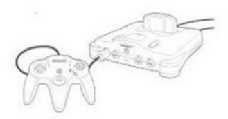
La manette de la Nintendo 64 contient un joystick qui utilise un système analogique pour la lecture des angles et de la direction de ses mouvements. Un tel système permet un contrôle dont la subtilité dépasse de loin celle d'une manette conventionnelle.
